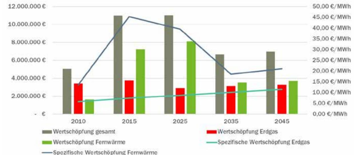
Abbildung 53: Wertschöpfungssystemvergleich Fernwärme und Erdgas
